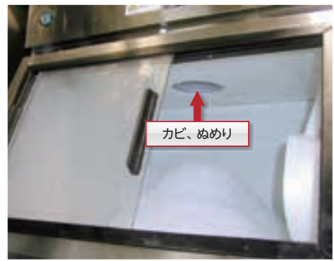
図4 清掃漏れの例(製氷機内)
