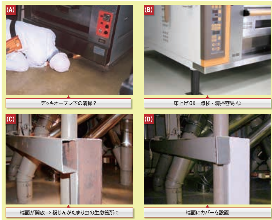
図6 機械・設備の設置方法の例
